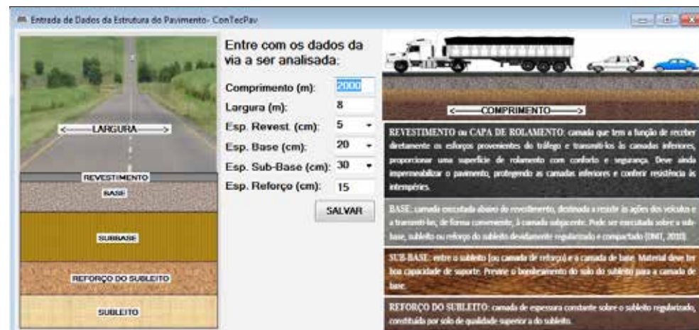
Figura 11: Dados necessários para determinar os tipos e quantitativos de ensaios
