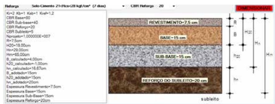
Figura 14: Verificação das espessuras da estrutura do pavimento
