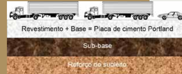
Figura 1: Pavimento rígido constituído por placa de concreto, sub-base e reforço do subleito
